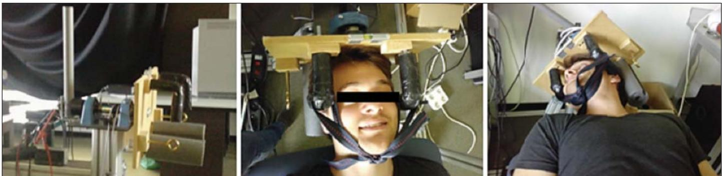
› Figure 1 : dispositif de mesure que nous avons utilisé dans notre étude. Il comprend un support où fixer la tête des sujets, un levier permettant d'induire les rotations de la tête, un niveau à bulle servant à vérifier la position neutre de la tête, un goniomètre et un couple-mètre
